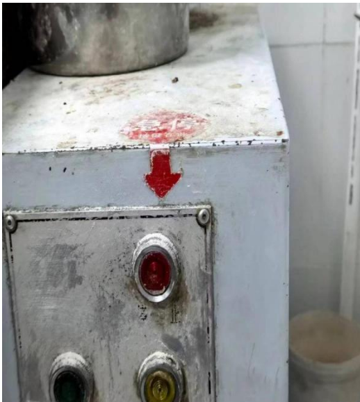
图 7：和面机停止开关
